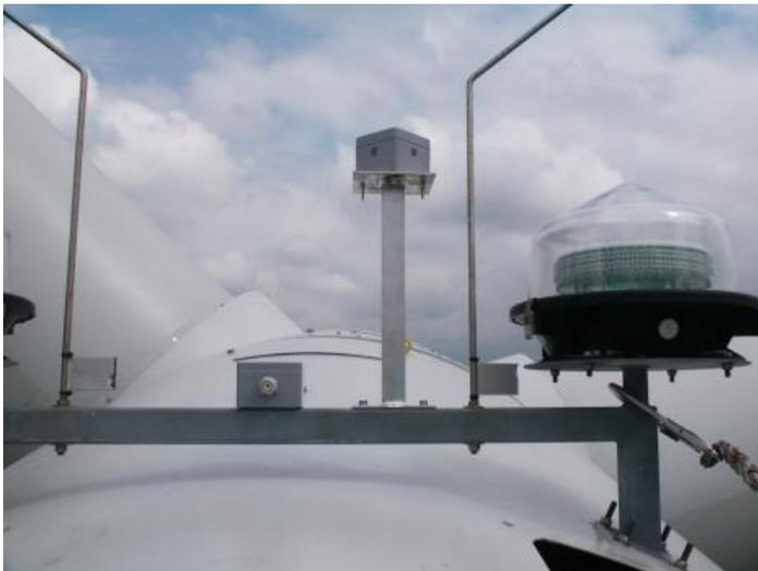
Illustration 2. Un capteur fixé au-dessus de la nacelle d'une éolienne.
