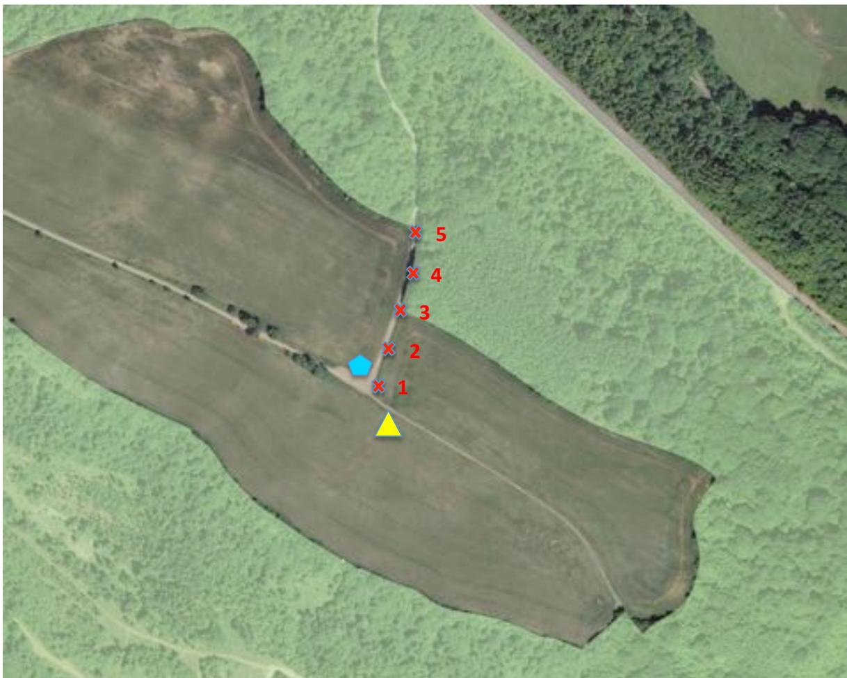
Abbildung 8: Lage des Windmessmast (blaues Fünfeck) und der horizontalen Messreihe bestehend aus 5 batcordern (rote Kreuze) im geplanten Windpark Differdange - Obercorn. Der geplante Standort der WEA 3 ist durch ein gelbes Dreieck markiert. Kartengrundlage: map.geoportal.lu.
