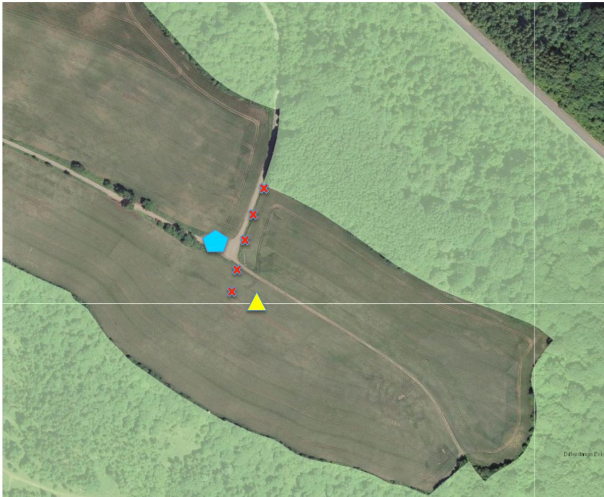
Abbildung 3: WEA 3 und Vorschläge der Positionen einer systematischen Messreihe, die die Flugroutennutzung entlang der Schutzgebiets- und Gehölzgrenze horizontal überprüft. Gelbes Dreieck: WEA 3, blaues Fünfeck: Maststandort, rote Kreuze: akustische Geräte zur systematischen Erfassung der Flugroute.
