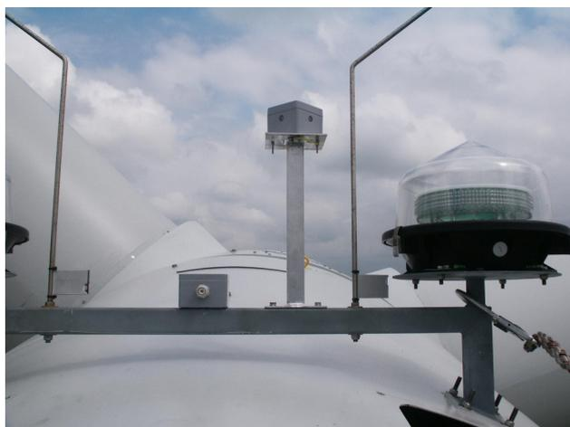
Abbildung 2. Oben auf der WEA-Gondel angebrachter Sensor.
