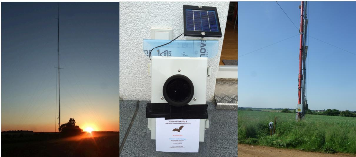
**Abbildung 7: Windmessmast zwischen den geplanten WEA-Standorten 2 und 3. Die beiden batcorder-Waldboxen wurden in 50 m und 100 m Höhe angebracht und über drei Jahre während der fledermausrelevanten Zeiträume betrieben.**
