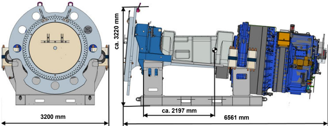
Abb. 3 Maße Triebstrang auf Transportvorrichtung (Werte variantenabhängig)
