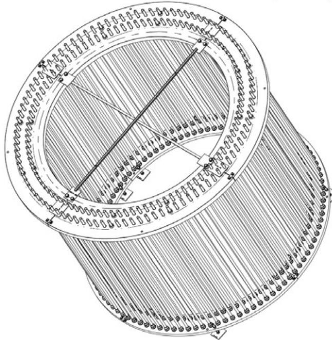
Abb. 10 Beispiel für einen Ankerkorb mit 4 x 50 Ankerbolzen
