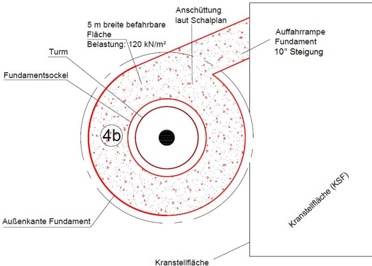
Abb. 24 Fläche um den Turm in Draufsicht (Hybridturm)
