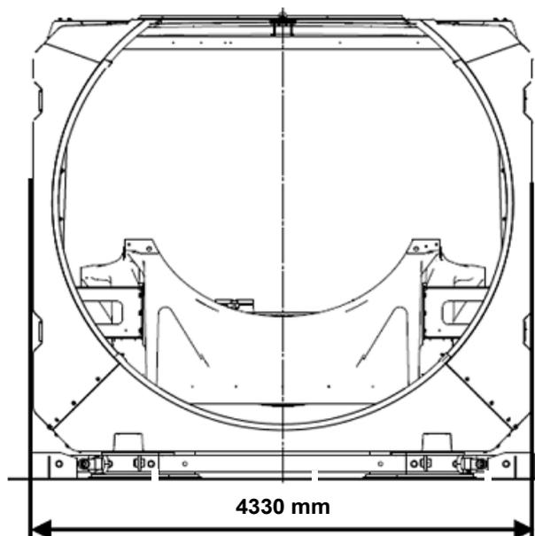
Abb. 2 Maschinenhaus (Ansicht von vorn) mit Transportfüßen
