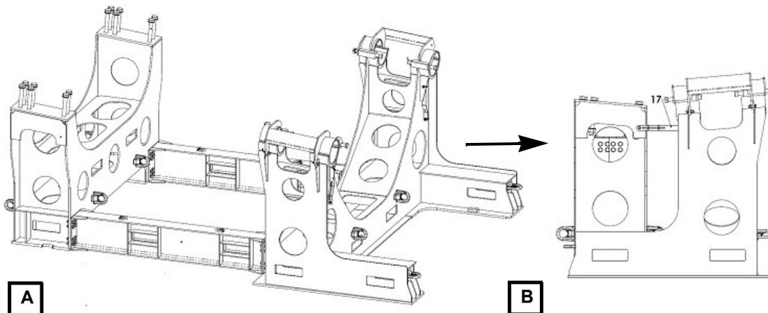
Abb. 8 Transportvorrichtung Triebstrang (A) und montiert für Rücktransport (B)
