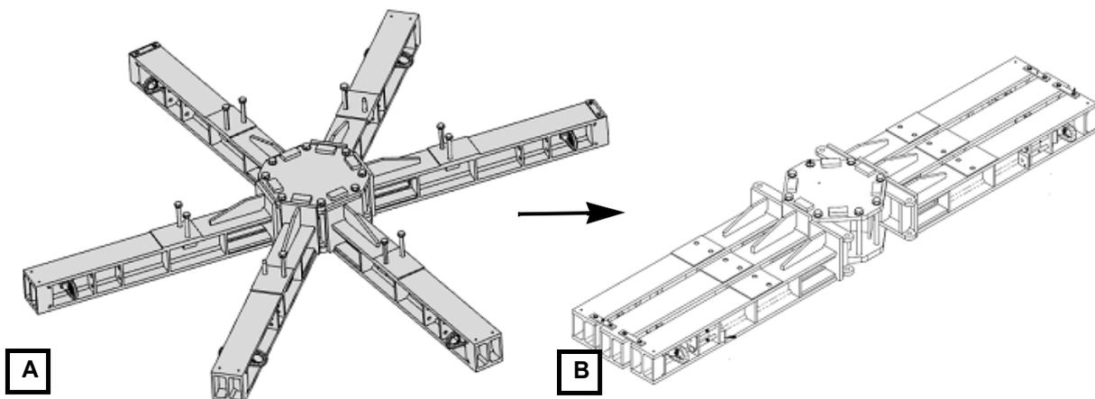
Abb. 9 Transportvorrichtung Nabe (A) und für Rücktransport (B)
