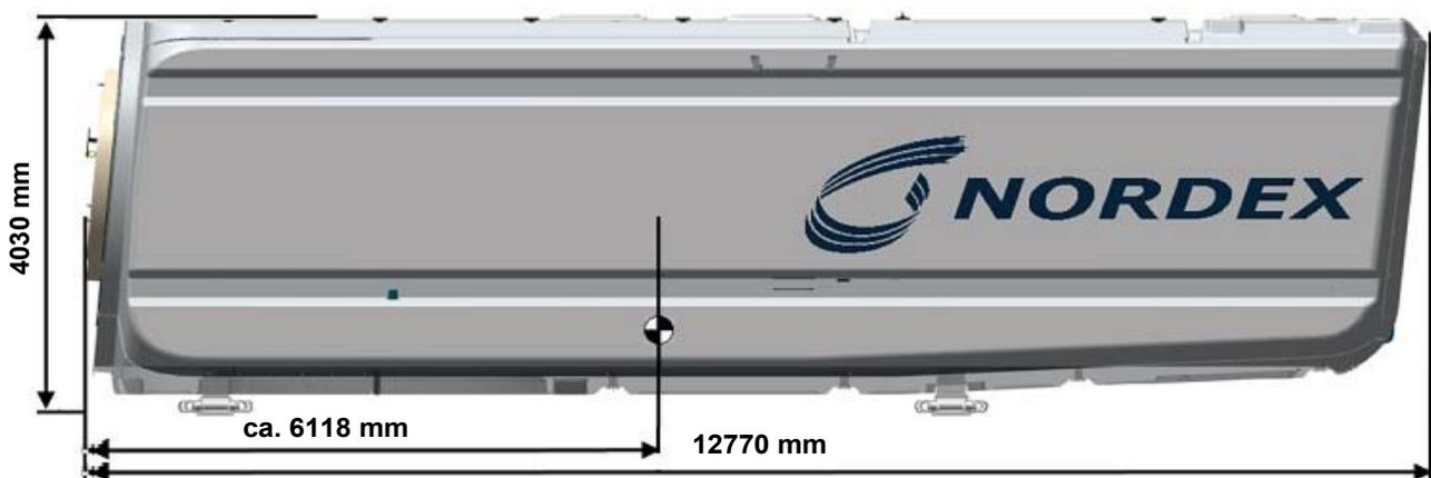
Abb. 1 Maschinenhaus (Ansicht von links) mit Transportfüßen
