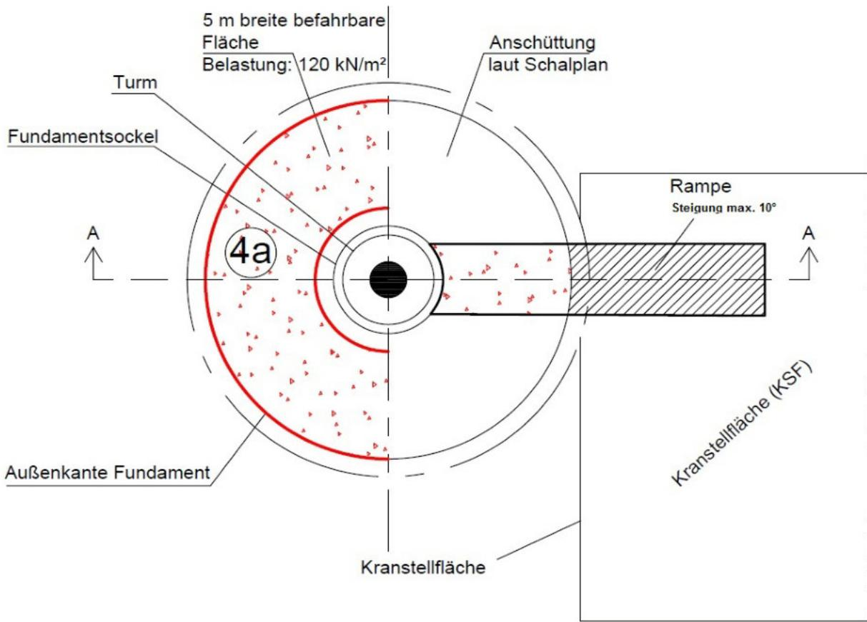
Abb. 23 Fläche um den Turm in Draufsicht (Stahlrohrturm)
