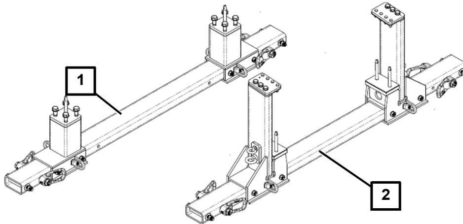
Abb. 7 Transportfüße Maschinenhaus vorn (1) und hinten (2)
