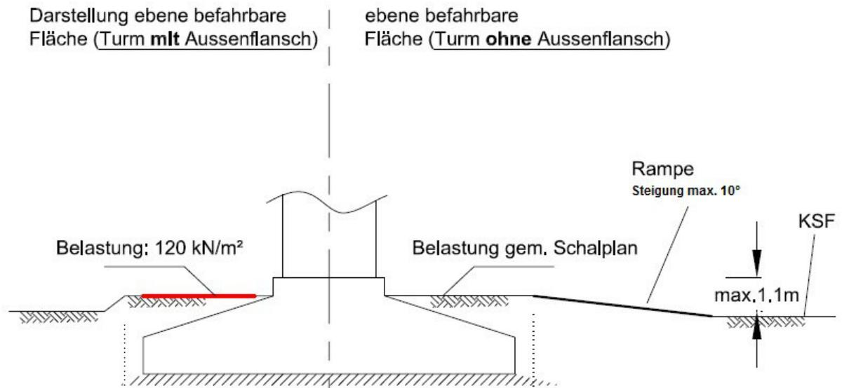
Abb. 22 Fläche um den Turm im Schnitt
