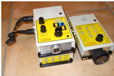
Figure 3: Systèmes Anabat : Anabat II (à gauche) et Anabat SD1 (à droite)
