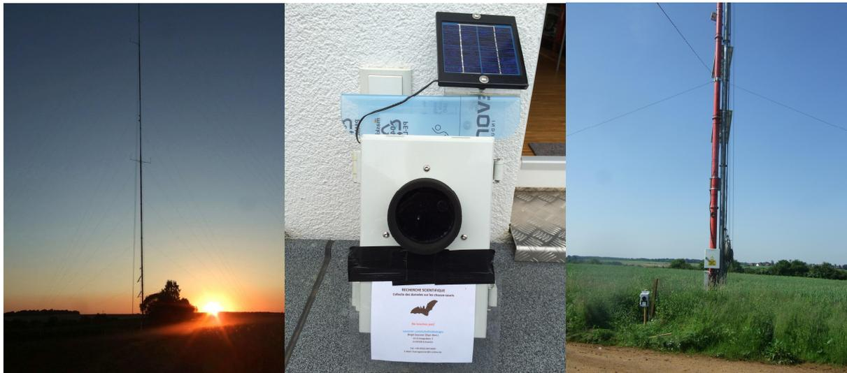
Figure 7: Mât de mesure du vent entre les sites prévus des éoliennes 2 et 3. Les deux boîtiers batcorder ont été installés à des hauteurs de 50 m et 100 m et ont été exploités pendant trois ans durant les périodes pertinentes pour les chauves-souris
