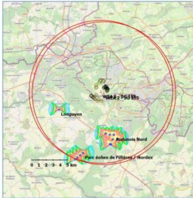
**Figure 4:** Précharge des installations existantes voisines et du parc éolien prévu "Audunois Nord".
